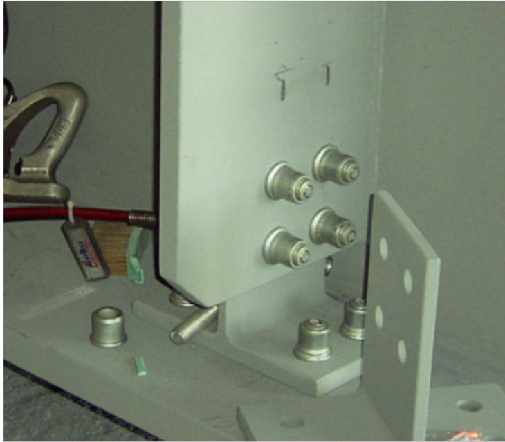
汽车铆钉固定紧固件是实现汽车零部件安装装配的主要元件，对紧固件在顶棚连接中的应用研究可以进一步了解汽车设计连接的方式，先将塑料简易铆钉固定到检具架上，将拉绳机构松开刹车线；将定位块安装到顶棚上；定位块安装好后，将顶棚随定位块一起放置到塑料简易铆钉上。拉绳机构拉紧刹车线，刹车线推动简易铆钉卡紧定位块，顶棚安装完成；顶棚检测好后，拉绳机构松开刹车线，刹车线松开时塑料简易铆钉松开定位块，定位块和顶棚一起取出；将定位块从顶棚上拆下，将顶棚安装在定位块上，顶棚随着夹紧或脱开的定位块整体安装或者整体脱落，安装定位准确，避免产品损坏或变形，具有提高顶棚安装的效率，降低安装难度。墩铆式铆钉属于虎克铆钉吗？江西短尾虎克铆钉LMY-T20-
